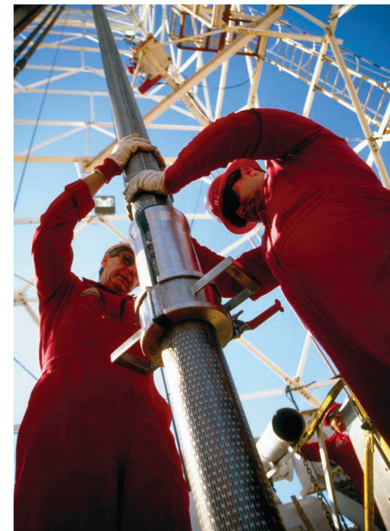
Sleufperforatie in Roestvast staal
